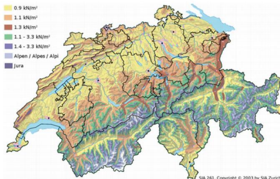
Forces exercées par le vent (source SIA)
