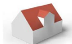
Lucarne en pignon
